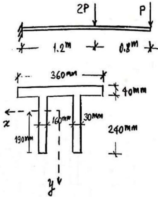
Şekildeki konsol kiriş  $P$  ve  $3P$  tekil yüklerinin etkisindedir.  $\sigma_{güv} = 120 \text{ MPa}$  olarak verildiğine göre Tresca varsayımını kullanarak  $P$  yükünün alabileceği en büyük değeri hesaplayınız.
