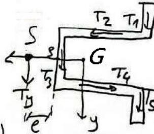
Şekildeki ince cidarlı ( $t \ll a$ ), sabit  $t$  kalınlıklı açık profil kesite kayma merkezi K dan etkileyen kesme kuvveti  $T_y = 80 \text{ kN}$  dur,  $a = 120 \text{ mm}$ ,  $t = 8 \text{ mm}$ .
