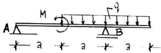
Sekildeki aksmazlı kirişin elastik eğri ifadesini Diferansiyel denklem yöntemiyle bulunur.
