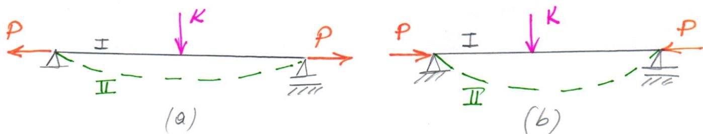
"Şekil a" da görülen  $P$  çekme kuveti etkisi altında I denge konumun dolu bir kırıçın bir " $K$ " kuveti etki ederse  $K$  II denge konumunu alır. " $K$ " kuveti kaldırılığında kırıç I konumuna geri gelir. Dolayısıyla bu yüklenme altında kırıçın dengesi her zaman kararlıdır.
