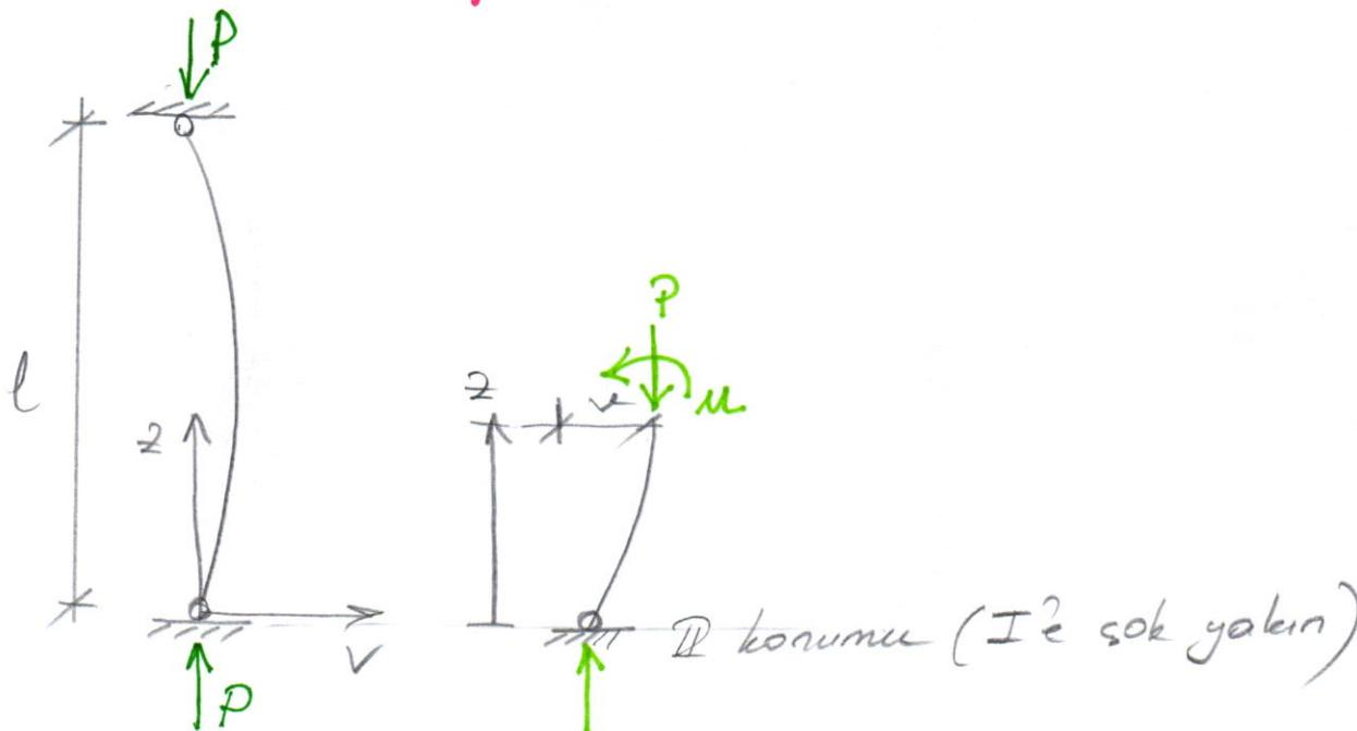
Yukarıdaki iki üçünden mafsalle çubukun I denge konumunun,  $P$  kuvvetinin hangi değerinde kararlı olacağını araştıralım. Bu araştırmada, çubuk ekseni doğru, yük eksenel, malzeme homojen olup Hooke Kanunlarına uygun ve gerilmelein orantılı sınırlının altında bulun düşü kabul edilmiştir.
