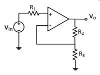
$$V_o = \frac{R_2 + R_3}{R_3} V_{in}$$
