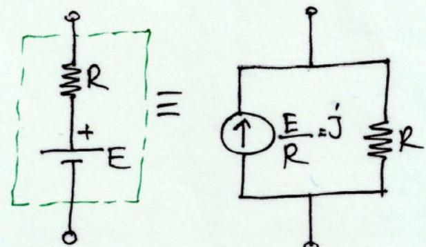
Gerilim kaynağının akım kaynağına dönüştürülmesi
