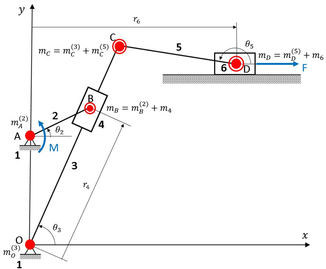
$m_2$  kütlesinin indirgenmesi :  $\overline{AB} = 20 \text{ mm}$ ,  $m_2 = 0,5 \text{ kg}$ ,  $L_A = 8 \text{ m}$ ,  $i_S^2 = 96 \text{ mm}^2$
