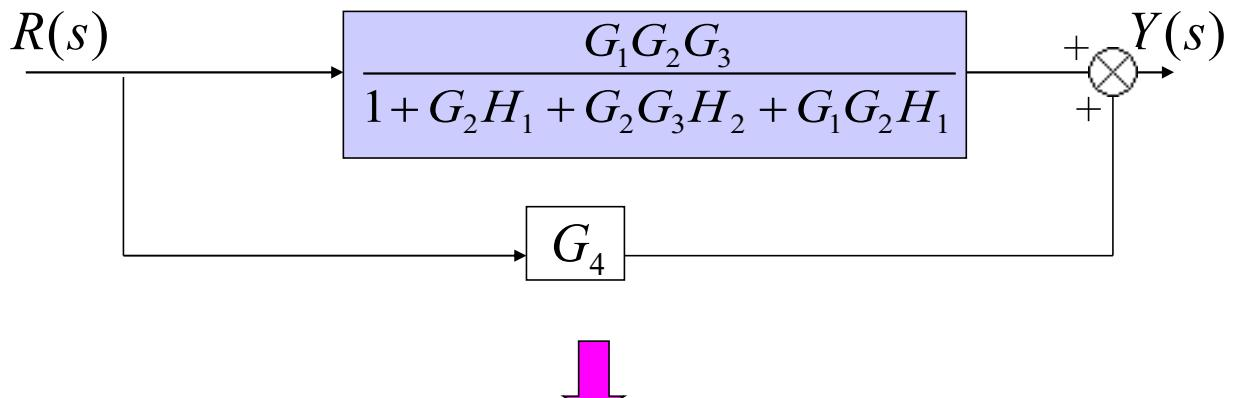
$$T(s) = \frac{Y(s)}{R(s)} = G_4 + \frac{G_1 G_2 G_3}{1 + G_2 H_1 + G_2 G_3 H_2 + G_1 G_2 H_1}$$
