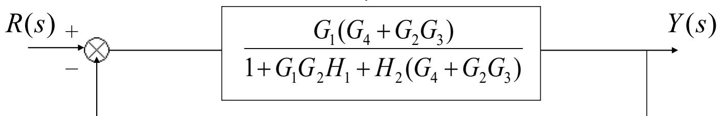
$$T(s) = \frac{Y(s)}{R(s)} = \frac{G_1(G_4 + G_2G_3)}{1 + G_1G_2H_1 + H_2(G_4 + G_2G_3) + G_1(G_4 + G_2G_3)}$$
