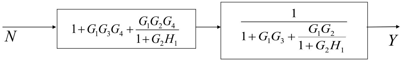
$$Y_2 = \frac{1 + G_2H_1 + G_1G_2G_4 + G_1G_3G_4 + G_1G_2G_3G_4H_1}{1 + G_2H_1 + G_1G_2 + G_1G_3 + G_1G_2G_3H_1} N$$
