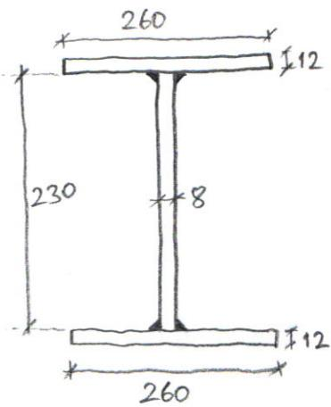
Yapma I enkesitten oluşturulan basit kiriş, ölü ve hareketli yükler altındadır. Basına etkisindeki kiriş baslığı mesnetlerde ve ortaklık ortasında yanal olarak desteklenmiştir. Kirişin eğilme etkisinde kontrolü yapınız.
