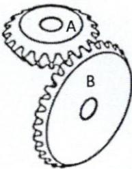
Yarıçapı  $r_A = 25 \text{ mm}$  olan A dişlisi, yarıçapı  $r_B = 100 \text{ mm}$  olan B dişlisi ile şekilde gösterildiği gibi iç içe geçmiş durumdadır. A dişlisi durgun halden, sabit  $\alpha_A = 2 \frac{\text{rad}}{\text{s}^2}$  açısal ivmesi ile harekete başlamaktadır.
