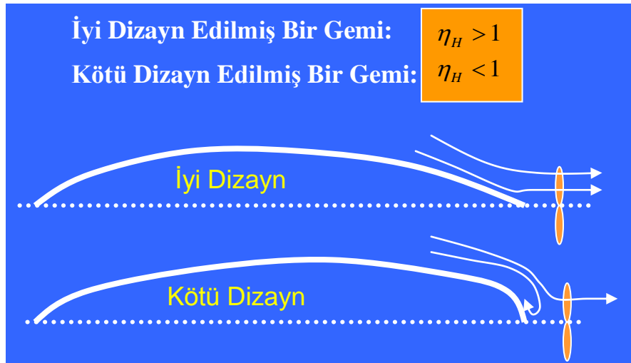
Şekil 8.4 Tekne verimi açısından iyi ve kötü dizayn örnekleri.
