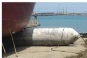
Şekil 4. Balonların şişirilmesi ve kontrolü
