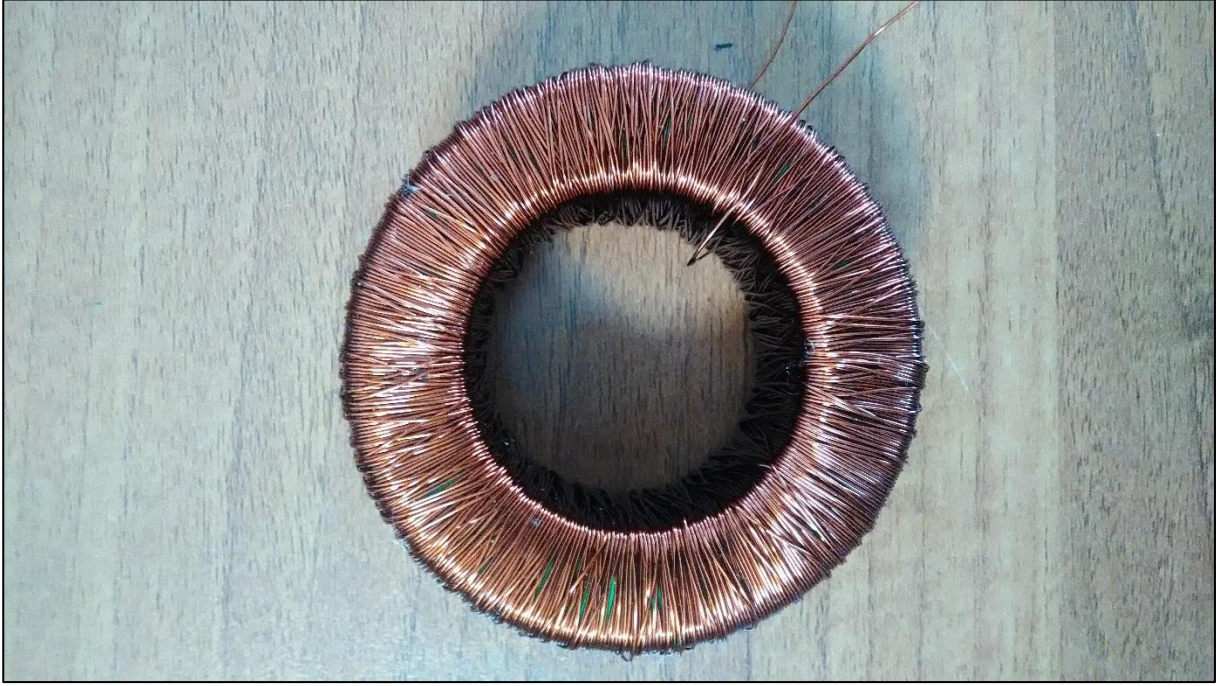
Şekil 6: Üzerine bakır bobin teli sarılmış ferromanyetik nüve
