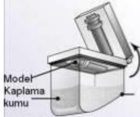
1. Model çevrilir ve kutuya tespit edilir
