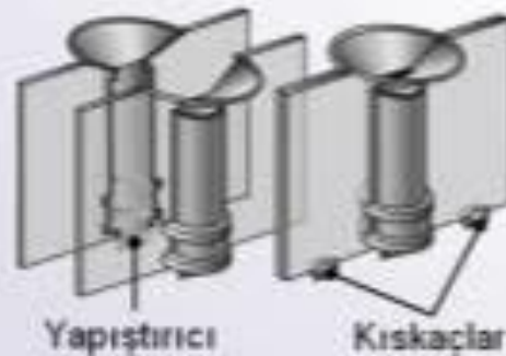
5. Kalıp yarıları birbirine yapıştırılır
