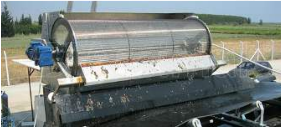
Döner elek sisteminin kesiti ve bu eleklerin sürekli sistemde kullanımı
