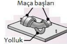
Maça başları Yolluk Üst derece levhası (c)
