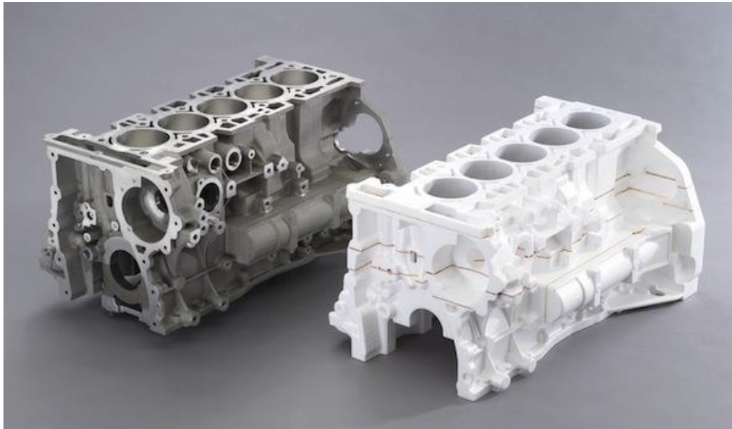
Köpük model ve döküm parça
