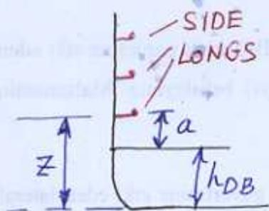
$$W_L = \frac{83}{\bar{\sigma}_{pr}} \cdot m \cdot a \cdot l^2 \cdot p \text{ [cm}^3\text{]} \quad (\text{B } 3.1)$$
