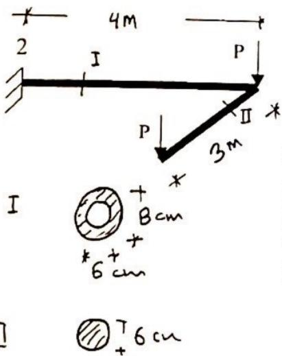
Şekildeki L çubuğu yatay düzlemede ve  $P$  kuvvetleri düşey doğrultudadır. Malzeme  $\sigma_{\text{gür}} = 14 \text{ KN/cm}^2$  olarak verildiğine göre  $P$ 'nin uygun değerini hesaplayınız. Sadece eğilme veya eğilmeli burulma halleri dikkate alınacaktır. Gerekirse biçim değiştirme enerjisi kullanılacaktır.
