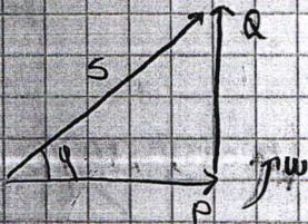
$\phi > 0$  ⇒ Endüktif karakteristik yükler ait güç üçgeni (motor, RL vb)
